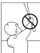
**■ ATENȚIE!** Fixarea necorăspunzătoare poate cauza accidente grave și fatale. Galeria trebuie montată pe perete în mod corespunzător, pentru a impiedica cădere. Șurubul, elementul de fixare, diblul trebuie ales în funcție de calitatea peretelui, în plus trebuie verificat și rezistența lor.
