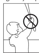
**■ PAŽNJA!** Netočno učvršćivanje profila može prouzročiti teške nesreće, čak i smrtnе ozljede. Da biste sprječili pad profila, mora biti pravilno pričvršćen na zid. Uvijek odaberite pravu vrstu vijaka, tipla, nosača prema kvaliteti zida vašeg doma i provjerite nosivost da li odgovara.
